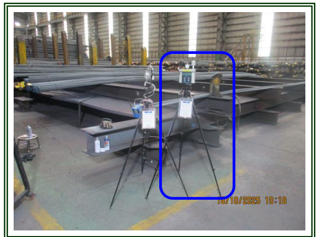
รูปที่ 4-64 ตรวจวัดระดับความร้อนบริเวณลานนับเหล็กของผู้รับเหมา ตรวจวัดในวันที่ 18 ตุลาคม 2568
