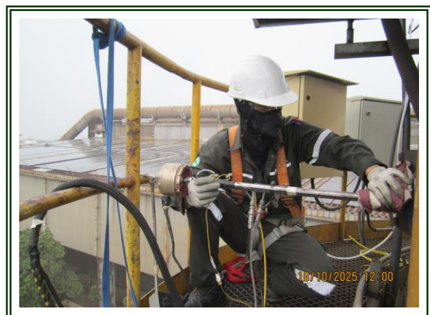
รูปที่ 4-48 ตรวจวัดปล่องของเตาอบเหล็กแท่ง (RHF) ตรวจวัดในวันที่ 18 ตุลาคม 2568
