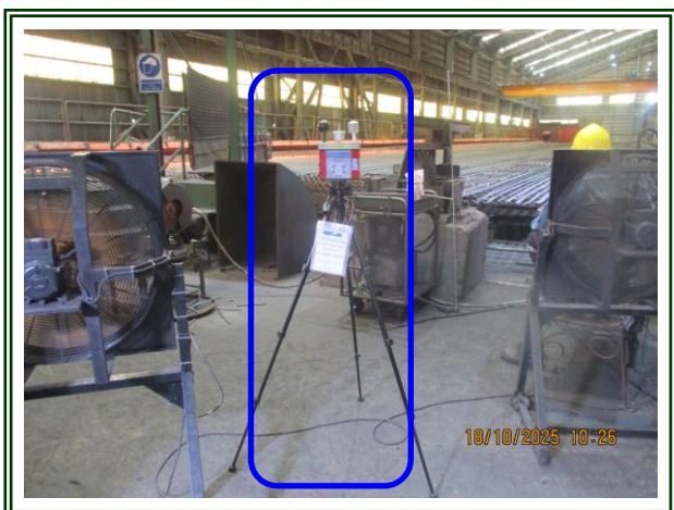
รูปที่ 4-65 ตรวจวัดระดับความร้อนบริเวณ Pendulum Shear ตรวจวัดในวันที่ 18 ตุลาคม 2568
