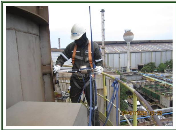
รูปที่ 4-45 ตรวจวัดปล่องที่ผ่านโรงกำจัดฝุ่น (Fume Plant # 2) ตรวจวัดในวันที่ 21 กรกฎาคม 2568
