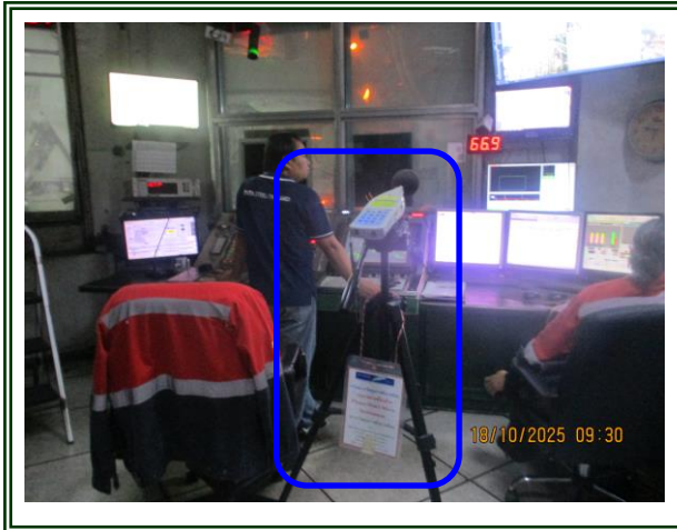
รูปที่ 4-85 ตรวจวัดระดับเสียงในพื้นที่การทำงาน บริเวณเตาหลอมเหล็ก EAF (ห้องควบคุม) ตรวจวัดในวันที่ 18 ตุลาคม 2568
