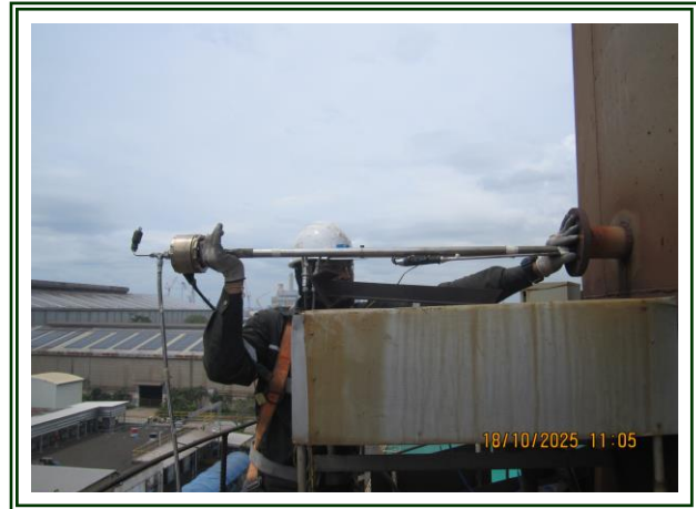
รูปที่ 4-44 ตรวจวัดปล่องที่ผ่านโรงกำจัดฝุ่น (Fume Plant # 1) ตรวจวัดในวันที่ 18 ตุลาคม 2568
