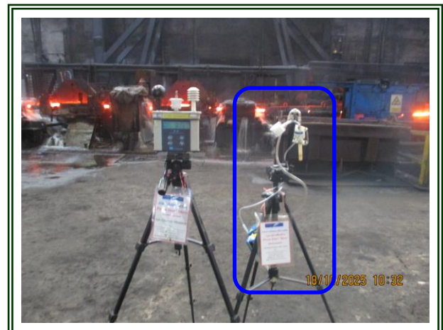
รูปที่ 4-58 ตรวจวัดฝุ่นละอองบริเวณแท่นรีดเหล็ก เก็บตัวอย่างในวันที่ 18 ตุลาคม 2568
