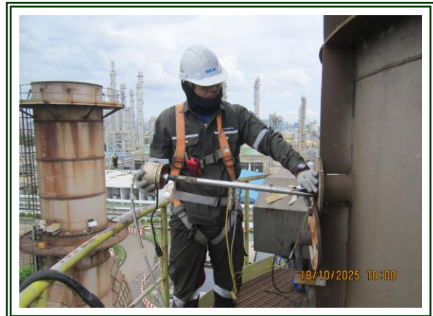
รูปที่ 4-46 ตรวจวัดปล่องที่ผ่านโรงกำจัดฝุ่น (Fume Plant # 2) ตรวจวัดในวันที่ 18 ตุลาคม 2568
