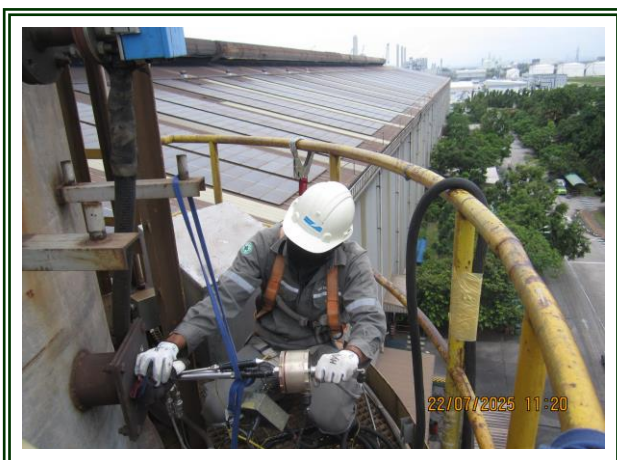
รูปที่ 4-47 ตรวจวัดปล่องของเตาอบเหล็กแท่ง (RHF) ตรวจวัดในวันที่ 22 กรกฎาคม 2568
