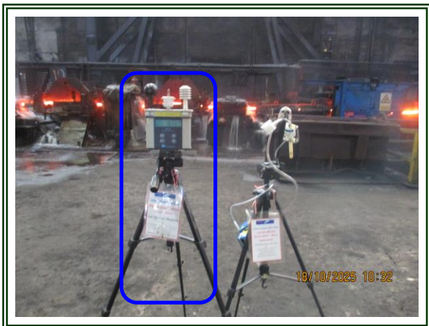
รูปที่ 4-63 ตรวจวัดระดับความร้อนบริเวณแท่นรีดเหล็ก ตรวจวัดในวันที่ 18 ตุลาคม 2568
