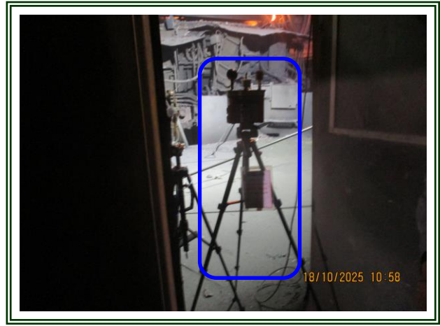
รูปที่ 4-62 ตรวจวัดระดับความร้อนบริเวณเตาหลอมเหล็ก ตรวจวัดในวันที่ 18 ตุลาคม 2568
