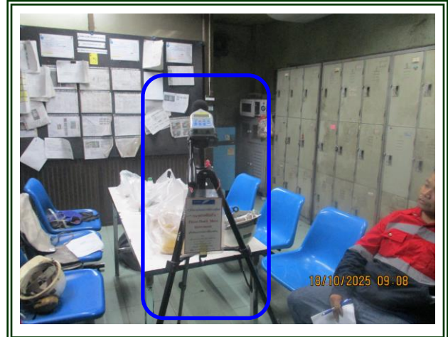
รูปที่ 4-86 ตรวจวัดระดับเสียงในพื้นที่การทำงาน บริเวณเครื่องหล่อเหล็กแท่ง (ห้องควบคุม) ตรวจวัดในวันที่ 18 ตุลาคม 2568
