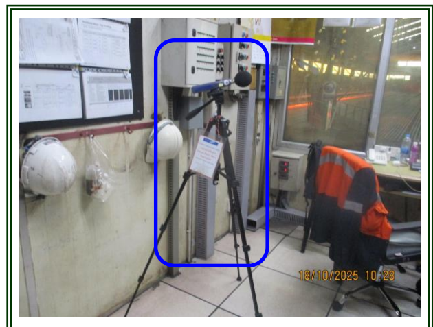
รูปที่ 4-88 ตรวจวัดระดับเสียงในพื้นที่การทำงาน บริเวณ Pendulum Shear (ห้องควบคุม) ตรวจวัดในวันที่ 18 ตุลาคม 2568
