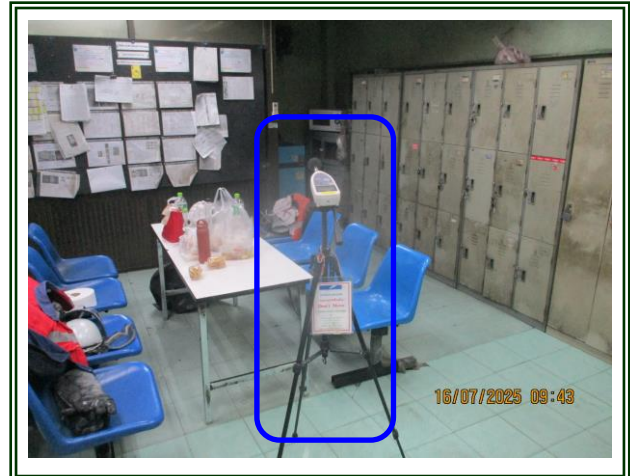
รูปที่ 4-82 ตรวจวัดระดับเสียงในพื้นที่การทำงาน บริเวณเครื่องหล่อเหล็กแท่ง (ห้องควบคุม) ตรวจวัดในวันที่ 16 กรกฎาคม 2568
