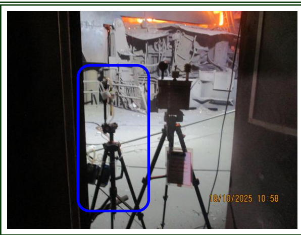
รูปที่ 4-57 ตรวจวัดฝุ่นละอองบริเวณเตาหลอมเหล็ก เก็บตัวอย่างในวันที่ 18 ตุลาคม 2568
