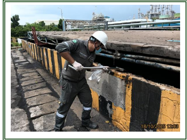
รูปที่ 4-56 เก็บตัวอย่างกากของเสีย Sludge Drying Bed เก็บตัวอย่างในวันที่ 18 ตุลาคม 2568
