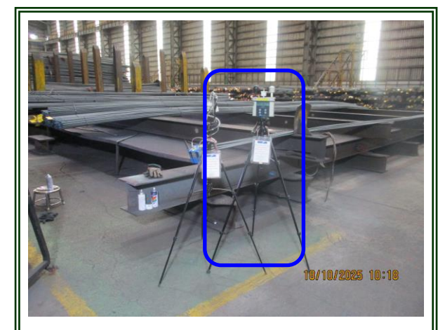
รูปที่ 4-60 ตรวจวัดฝุ่นละอองบริเวณลานนับเหล็กของผู้รับเหมา เก็บตัวอย่างในวันที่ 18 ตุลาคม 2568
