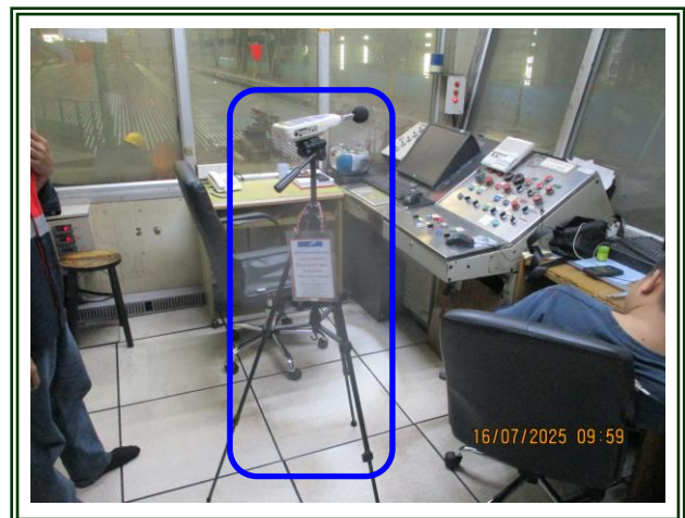
รูปที่ 4-84 ตรวจวัดระดับเสียงในพื้นที่การทำงาน บริเวณ Pendulum Shear (ห้องควบคุม) ตรวจวัดในวันที่ 16 กรกฎาคม 2568
