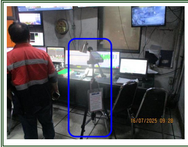
รูปที่ 4-81 ตรวจวัดระดับเสียงในพื้นที่การทำงาน บริเวณเตาหลอมเหล็ก EAF (ห้องควบคุม) ตรวจวัดในวันที่ 16 กรกฎาคม 2568
