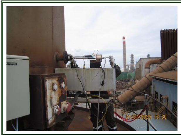
รูปที่ 4-43 ตรวจวัดปล่องที่ผ่านโรงกำจัดฝุ่น (Fume Plant # 1) ตรวจวัดในวันที่ 21 กรกฎาคม 2568
